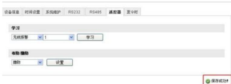
5. 从点击学习按钮后, 15s 以内, 打开无线门磁, 当无线门磁上的红灯亮时, 页面显示保存成功会有保存成功字样提醒, 即完成该序号无线门磁的接入。一旦接入这个无线门磁, C1 设备马上退出学习状态。C1 的 Alarm
