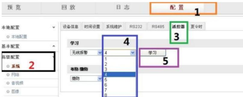
4. 在无线报警选项卡中, 选择学习选项卡, 下拉式复选框内是无线报警时, **选择接入序号 (若选择已经接入无线门磁的序号, 则新学习的无线门磁会冲掉之前已学习的无线门磁)**, 再点击“学习”按钮, 会有保存成功字样提醒 (如下图所示)。同时, C1 设备的 Alarm 灯红蓝双色同时点亮, 表明进行了学习状态, 时间限定约为 15s。
